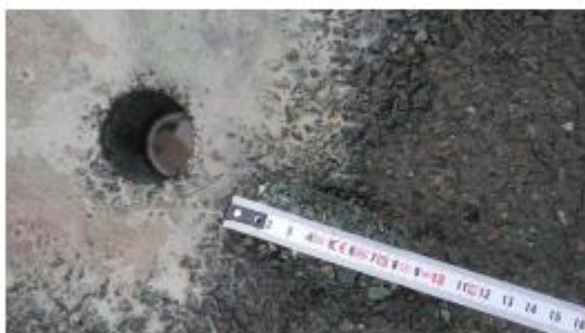
Prélèvement - P009 : ZONE LOGISTIQUE / EXTERIEURS / VOIRIE - Enrobé bitumineux- (Absence d'amiante)
