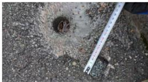
Prélèvement - P005 : ZONE LOGISTIQUE / EXTERIEURS / VOIRIE - Enrobé bitumineux- (Absence d'amiante)
