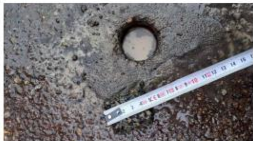
Prélèvement - P001 : ZONE LOGISTIQUE / EXTERIEURS / VOIRIE - Enrobé bitumineux- (Absence d'amiante)
