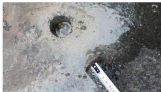
Prélèvement - P024 : ZONE LOGISTIQUE / EXTERIEURS / VOIRIE - Enrobé bitumineux- (Absence d'amiante)
