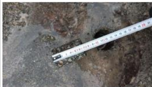
Prélèvement - P022 : ZONE LOGISTIQUE / EXTERIEURS / VOIRIE - Enrobé bitumineux- (Absence d'amiante)
