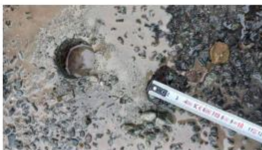
Prélèvement - P012 : ZONE LOGISTIQUE / EXTERIEURS / VOIRIE - Enrobé bitumineux- (Absence d'amiante)
