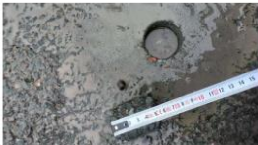
Prélèvement - P015 : ZONE LOGISTIQUE / EXTERIEURS / VOIRIE - Enrobé bitumineux- (Absence d'amiante)
