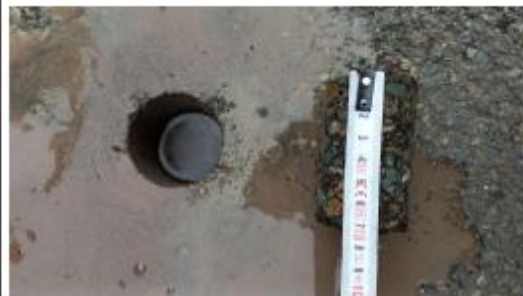
Prélèvement - P016 : ZONE LOGISTIQUE / EXTERIEURS / VOIRIE - Enrobé bitumineux- (Absence d'amiante)
