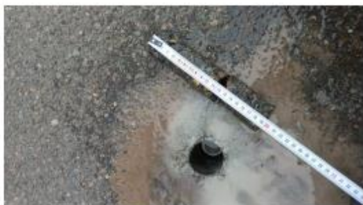
Prélèvement - P017 : ZONE LOGISTIQUE / EXTERIEURS / VOIRIE - Enrobé bitumineux- (Absence d'amiante)
