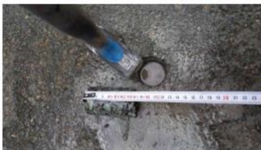
Prélèvement - P007 : ZONE LOGISTIQUE / EXTERIEURS / VOIRIE - Enrobé bitumineux- (Absence d'amiante)
