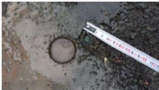
Prélèvement - P013 : ZONE LOGISTIQUE / EXTERIEURS / VOIRIE - Enrobé bitumineux- (Absence d'amiante)
