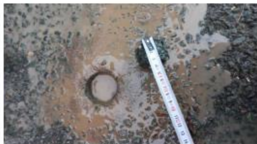
Prélèvement - P003 : ZONE LOGISTIQUE / EXTERIEURS / VOIRIE - Enrobé bitumineux- (Absence d'amiante)
