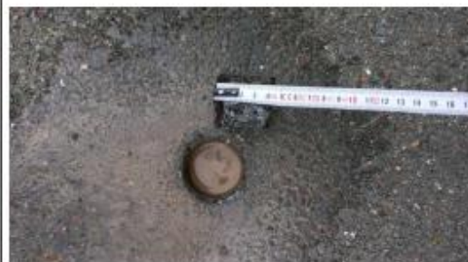
Prélèvement - P006 : ZONE LOGISTIQUE / EXTERIEURS / VOIRIE - Enrobé bitumineux- (Absence d'amiante)
