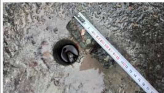
Prélèvement - P023 : ZONE LOGISTIQUE / EXTERIEURS / VOIRIE - Enrobé bitumineux- (Absence d'amiante)
