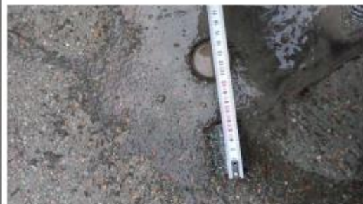
Prélèvement - P004 : ZONE LOGISTIQUE / EXTERIEURS / VOIRIE - Enrobé bitumineux- (Absence d'amiante)
