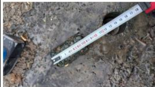
Prélèvement - P002 : ZONE LOGISTIQUE / EXTERIEURS / VOIRIE - Enrobé bitumineux- (Absence d'amiante)
